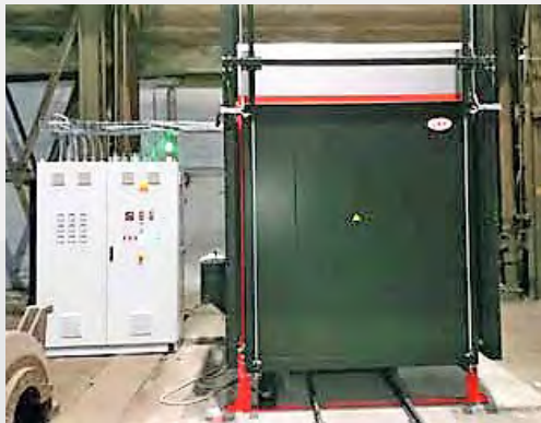
Electric annealing furnace VKNC 7200 in Vítkovické slévárny, spol. s r.o.
