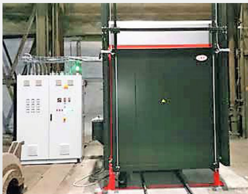
Elektrická žihací pec VKNC 7200 ve společnosti Vítkovické slévárny, spol. s r.o.
