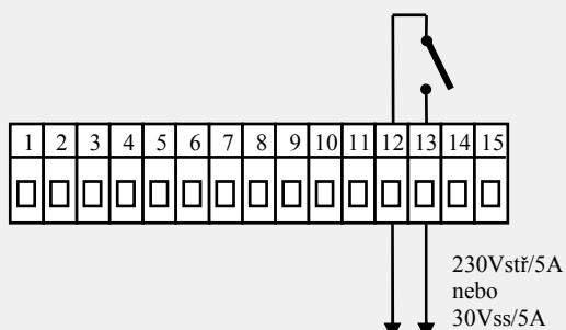
Výstup RELÉ *je galvanicky oddělený od země přístroje*. U tohoto výstupu je nutné vnější vodiče fixovat tak, aby v případě uvolnění vodiče ze svorky nedošlo ke snížení izolace mezi kategoriemi síťového napětí a bezpečného napětí.
