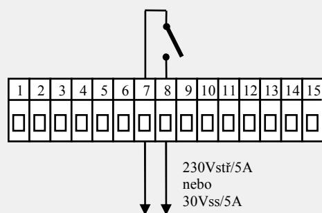
Výstup RELÉ je galvanicky oddělený od země přístroje. U tohoto výstupu je nutné vnější vodiče fixovat tak, aby v případě uvolnění vodiče ze svorky nedošlo ke snížení izolace mezi kategoriemi sítového napětí a bezpečného napětí.
