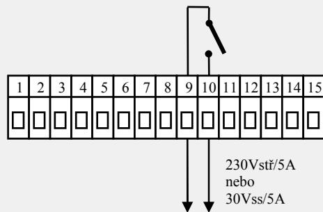
Výstup RELÉ *je galvanicky oddělený od země přístroje*. U tohoto výstupu je nutné vnější vodiče fixovat tak, aby v případě uvolnění vodiče ze svorky nedošlo ke snížení izolace mezi kategoriemi síťového napětí a bezpečného napětí.
