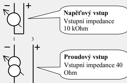
Měřící vstup není galvanicky oddělený od země přístroje
