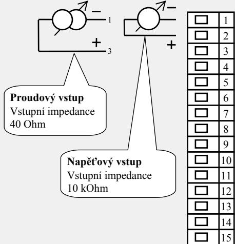
Měřicí vstup *není galvanicky oddělený od země přístroje*
