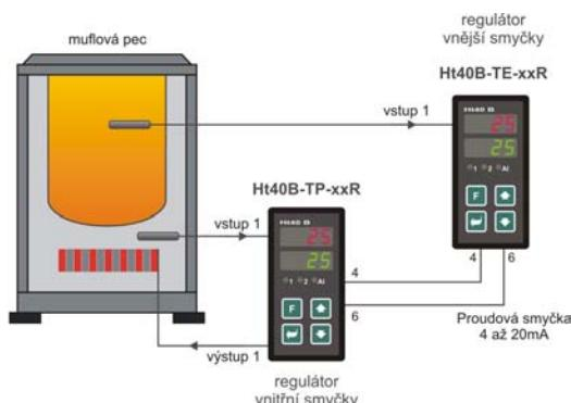
Kaskádní regulace je využívána v soustavách s **velkým dopravním zpožděním**, tj. v soustavách, kde odevzda na sepnutí akčního člena je příliš velká (např. u muflových pecí, ...).
