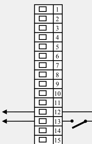
Výstup RELÉ je galvanicky oddělený od země přístroje. U tohoto výstupu je nutné vnější vodiče fixovat tak, aby v případě uvolnění vodiče ze svorky nedošlo ke snížení izolace mezi kategoriemi síťového napětí a bezpečného napětí.
