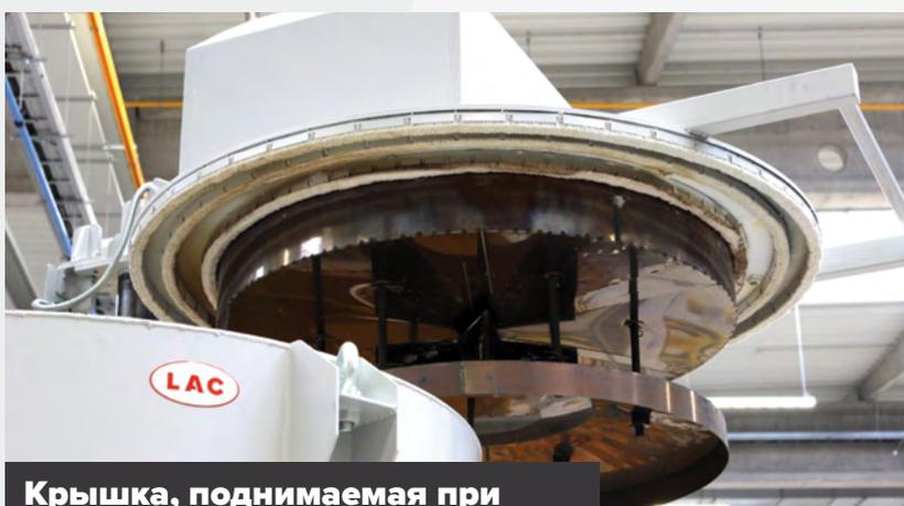
**Крышка, поднимаемая при помощи электрогидравлики**
