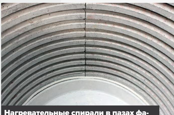
**Нагревательные спирали в пазах фасонных форм из жаропрочного бетона**
