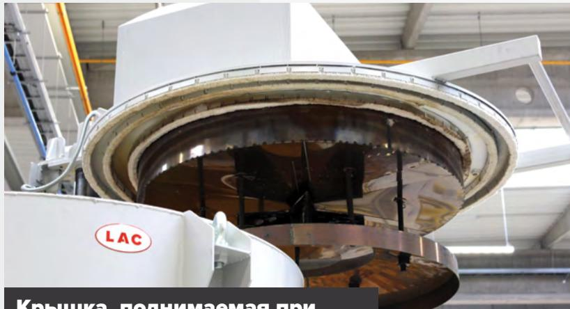
**Крышка, поднимаемая при помощи электрогидравлики**
