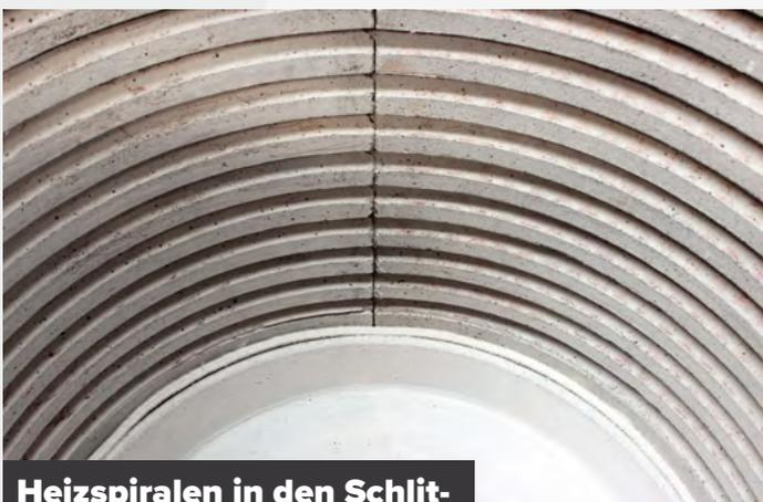
**Heizspiralen in den Schlitzen der Feuerbetonsteine**
