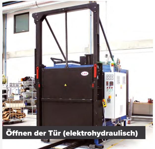
Öffnen der Tür (elektrohydraulisch)
